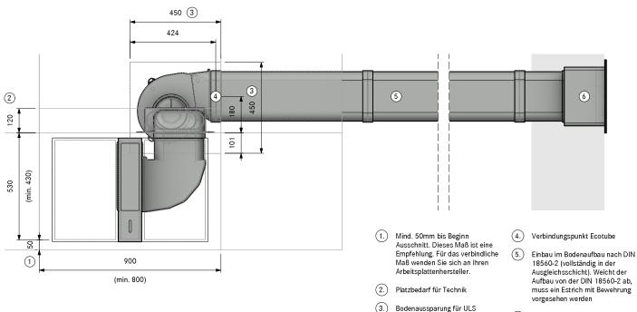
6. Mauerdurchbruch 310 x 155mm Ab Unterkante Durchbruch bis Mitte Kanal 71mm. Muss witterungsunabhängig gerade ausblasen
